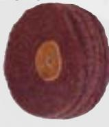
Éstos cepillos de fibra pre-impregnada están disponibles en tres grains, mediano, fino y duro. Se utilizan para acabados satinados, y para ciertos trabajos de micro-desbarbes, decapajes ligeros y limpieza. Se monta en taladradora (Ø100), torreta de pulido, o motor eléctrico con cono adaptador. Disponible en Ø100 con 4 discos, Ø150 con 5 discos, Ø200 con 6 discos.
